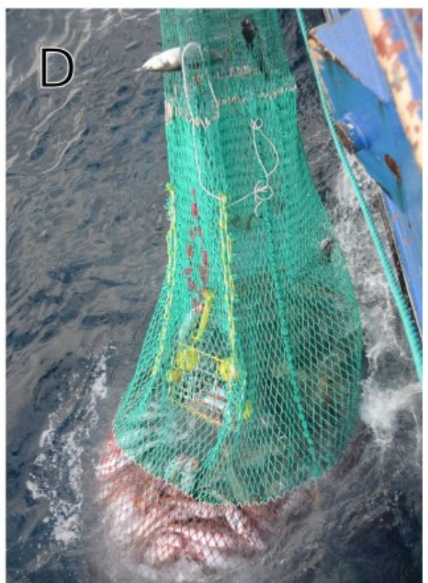
Figur 3. Fire utslippsanordninger som ble prøvt. A: Diamantmaske med kløft skåret fremover (utslipp 2). B: Spaghettimasker (utslipp 5). C: Trekantet utslippshull med dekknett (utslipp 7). D: To langsgående spalter (utslipp 4).
